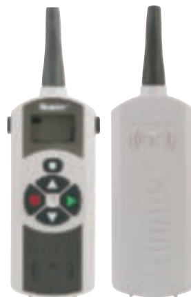
Трансмиттер и приемное устройство В 18 см × Ш 5,7 см × Г 3 см
